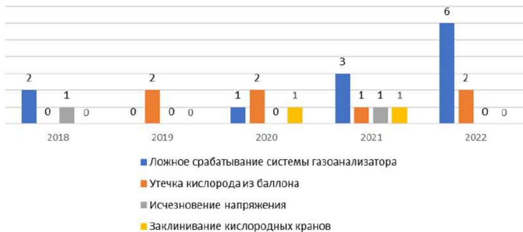
Рис. 1. Виды отказов на кислородно-наполнительной станции [1-5].
